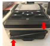
5. 将接线片折叠在电池末端, 然后更换电池盖。顺时针旋转指示条, 关闭并固定。
