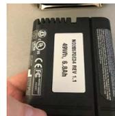
3. 要装载电池, 带槽触点应朝向左上方, 准备滑入仪器中, 如左图所示。
